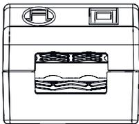
Sekundäre Zugentlastung für Kabel mit kleinerem Kabelmantel
